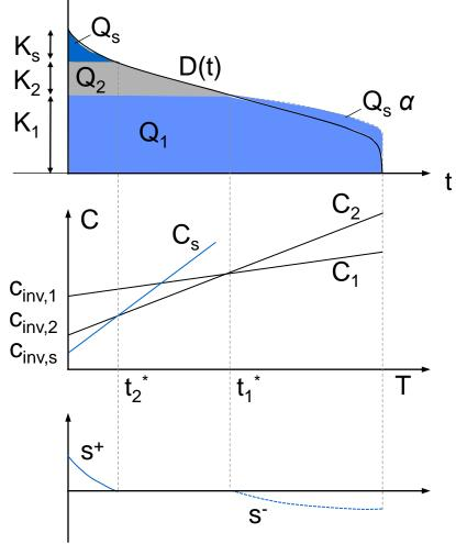
$$\begin{split} \min_{K_i, K_s} C(K_i, K_s) \\ &= \sum_i K_i c_{inv,i} + K_s c_{inv,s} + \sum_i Q_i c_{op,i} + Q_s \alpha c_{op,1} \\ \text{s.t.} \quad K_i, K_s \ge 0 \quad \forall i, \end{split}$$
